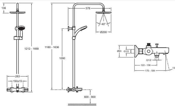
Спецификация продукта: Душевая колонна с термостатическим смесителем. E99741. Коллекция: JULY. РАЗМЕРЫ (СМ): 20 x 20 см. ТИП УСТАНОВКИ: Крепление к стене. АКСЕССУАРЫ: 0. НАЛИЧИЕ СМЕСИТЕЛЯ: СО СМЕСИТЕЛЕМ. ОДНОРЫЧАЖНЫЙ СМЕСИТЕЛЬ: ТЕРМОСТАТИЧЕСКИЙ. КЛАССИФИКАЦИЯ: ТЕРМОСТАТИЧЕСКИЙ. ФОРМА ВЕРХНЕГО ДУША: КРУГЛЫЙ. ПЕРЕКЛЮЧАТЕЛЬ: Встраиваемый. ТИП ШЛАНГА: Нескручивающийся.
